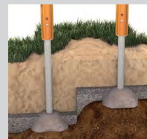
Zapuštěný základ S
