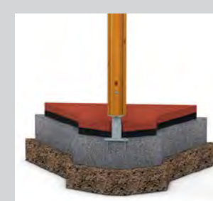
Nadzemní ukotvení OM
