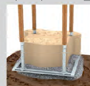
Zapuštěný prefabrikovaný betonový základ zasypaný pískem.
